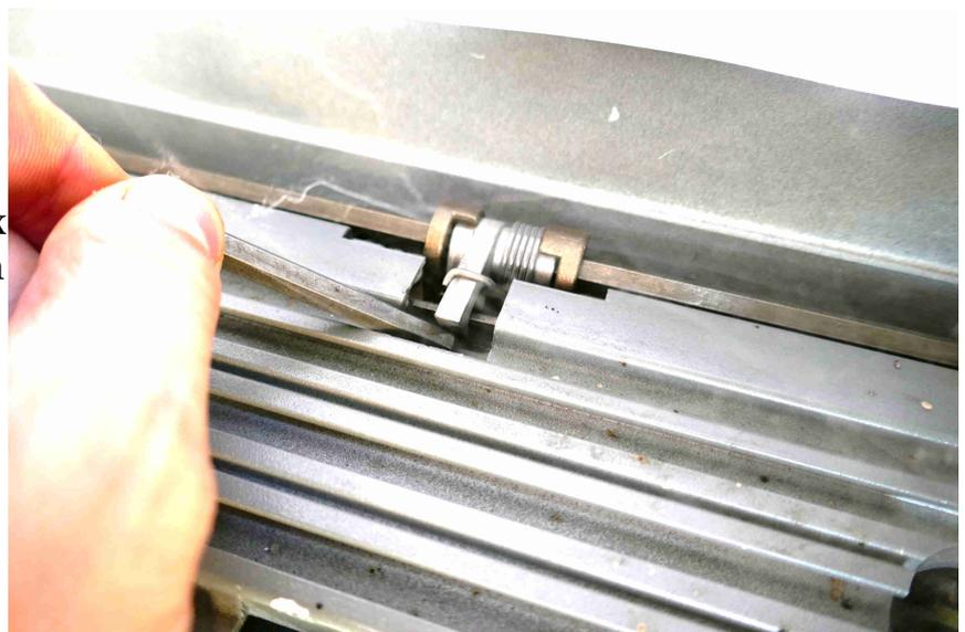
Dans les panneaux JCDecaux, les serrures se dévissent à l'aide d'une clé plate de 10. Pour la serrure trois points et la serrure créneaux il faut également une clé plate de 7.
